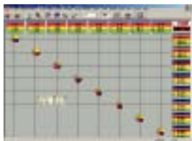
4レイヤー (ルーター) マトリクスビュー (クロスポイントロック機能) クロスポイントの色、I/Oのラベル名、アイコンの編集が可能、64x64などの大きなマトリクスをズーム表示可能
